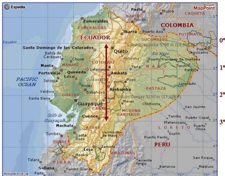
Figura 4.4: Localización geográfica de triangulación del Arco del Perú. Recorrieron alrededor de 400 km durante dos años. La flecha indica la longitud del arco de meridiano medido en Quito
