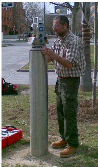
Figura 1.2: Estación total sobre vértice V3
