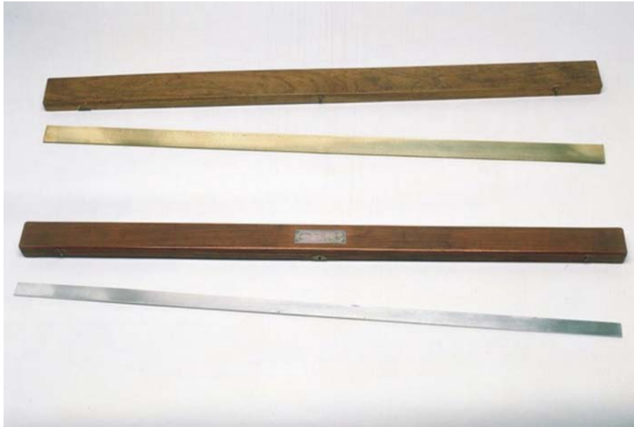
Figura 4.8: Patrones del primer prototipo de metro de 1799 en platino y copias en madera.
