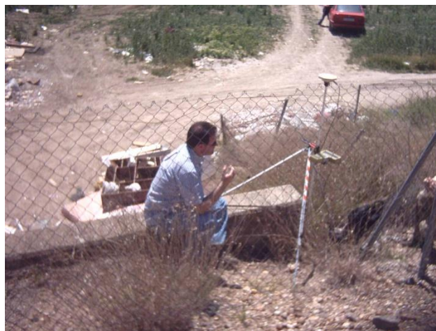
Figura 1.- Apoyo fotogramétrico. Medición utilizando GPS de doble frecuencia Leica
