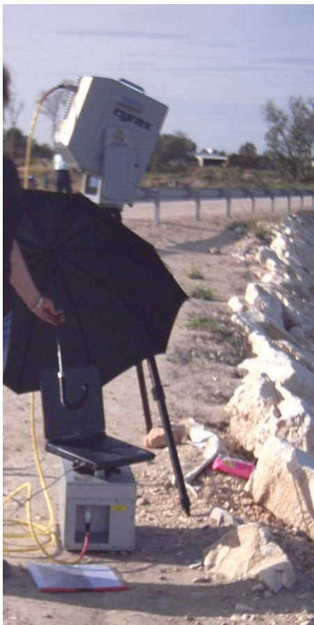
Figura 5.- Scanner láser modelo CYRAX distribuido por la firma LEICA
