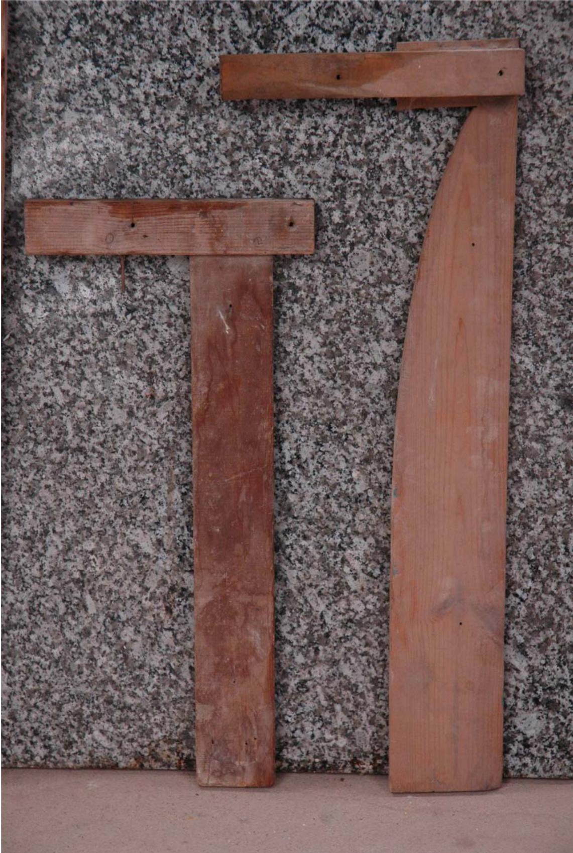
Figura 22: Taulaploms de madera de mobila para construcción de fuste, el de la izquierda, y de corona, el de la derecha, pertenecientes a Abelardo Martínez
