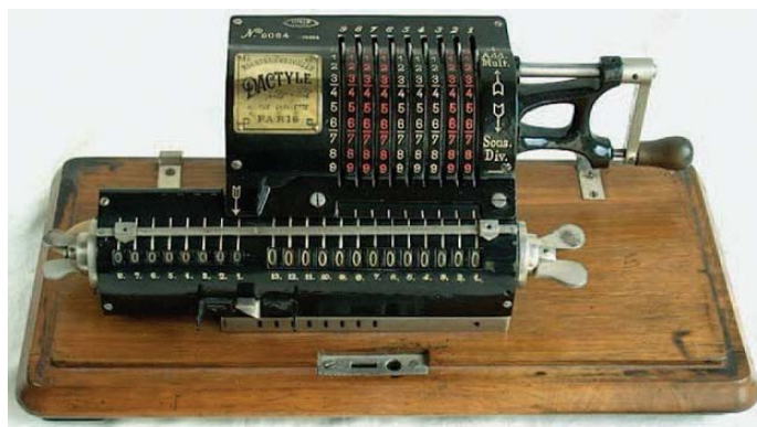
Figura 11: Calculadora de aguja y engranajes, patente Ruso-Sueca Willdgodt-Odhner. Comercializada por Dactyle – Brunswiga, modelo 1905
