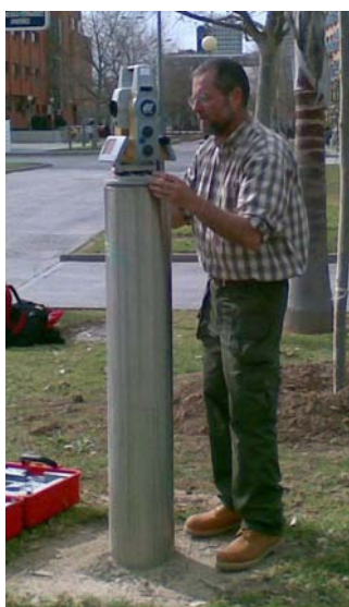
Figura 1.2: Estación total sobre vértice V3
