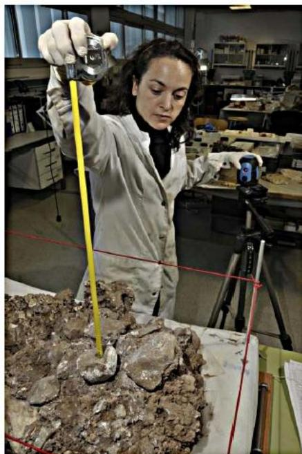
**Figura 30: Proceso de excavación y coordinado del Bloque CF10 N°5: toma de las cotas (Z) con la ayuda de un nivel láser.**
