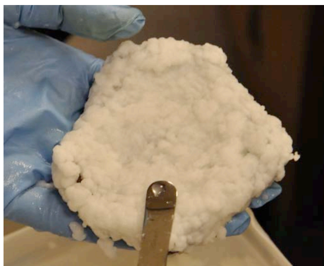
Figura 6: Limpieza de sales solubles (desalación) mediante emplastos.
