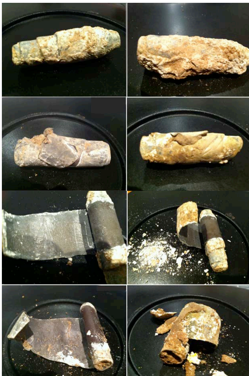
Figura 7: Lámina III. Fotografías de cuatro de los plomos tal y como se encontraron y durante el proceso de apertura de los rollos. Obsérvese el aparentemente logrado estado de corrosión exterior pulverulenta, disgregable, con abundantes restos de tierra y fuertes concreciones. Fotos: Amadeo Laborda.
